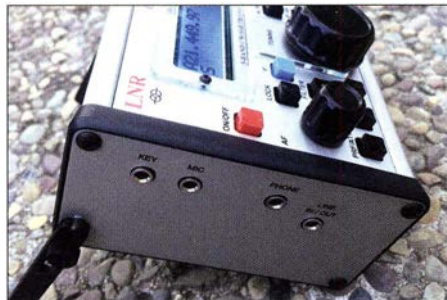
Bild 3: Auf der linken Seite befinden sich die Buchsen für Morsetaste, Mikrofon, Kopfhörer und Line In/Out.
