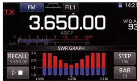
Bild 32: Dieses Diagramm zeigt die SWV-Verlaufskurve, nur leider meist nicht über ein ganzes Amateurband.
