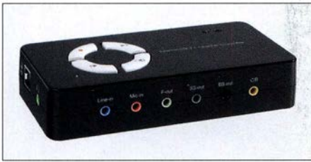
Bild 3: Die Soundkarte realisiert beim PC die Umsetzung des analogen Eingangssignals in digitale Daten; hier im Bild eine externe Version, die über die USB-Schnittstelle mit dem PC verbunden wird.
