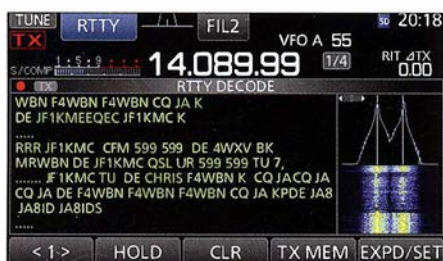
Bild 27: Der RTTY-Decoder bringt drei Abstimmhilfen mit: Spektroskop, Wasserfall und die „Icom-Waage“.
