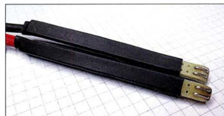
Bild 20: Das Prüfspitzenpaar aus Leiterplattenmaterial ist nach der Montage mit Schrumpfschlauch zu überziehen.
