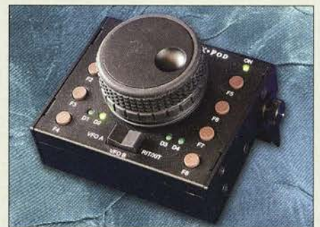
Die Zusatztasten des als Erweiterung für den Elecraft K3 und K3S dienenden sog. K-Pods lassen sich individuell mit Funktionen belegen. Direkt neben der PC-Tastatur positioniert, erübrigt sich dadurch etwa im Contest-Betrieb der Griff zur Transceiver-Frontplatte.
