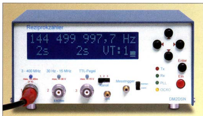
Bild 1: Selbst gebauter 400-MHz-Reziprozähler im Eigenbaugehäuse
