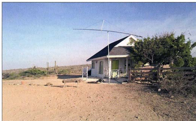
Funkstandort von P40MB in FK42XO im Westen der Insel; Azimut und Elevation wurden händisch eingestellt, um Rotoren und das damit verbundene Gewicht einzusparen.
