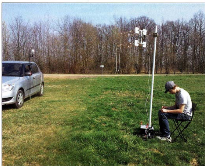
Bild 1: In freier Natur, weitab von störenden Signalen; der Messaufbau für die Helixantenne mit dem Sender am Fahrzeug und dem einige Meter entfernten Empfänger hat sich gut bewährt.
