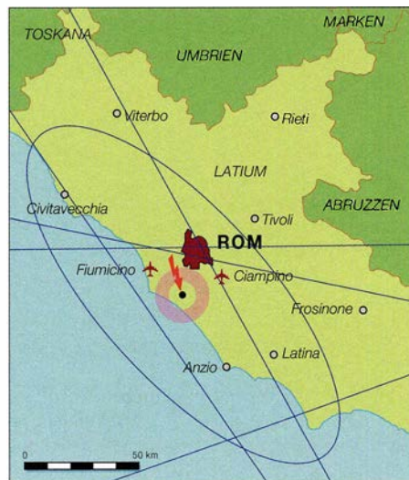
Aus den Peildaten errechnet das System eine Ellipse und darin einen Punkt, wo sich der gepeilte Sender vermutlich befindet.
