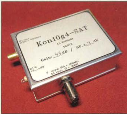
DG0VE zeigte Down- und Up-Converter für den geplanten Satelliten Es'hail-2, hier das Modul für 10-GHz-Empfang.
