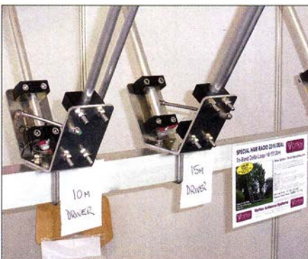
Vortex Antenna Systems setzt auf KW-Beams mit aufrecht stehenden Delta-Schleifen, hier die Einspeisungen für 10 m und 15 m; ein Draht bildet jeweils die dritte Dreiecksseite der Schleife.
