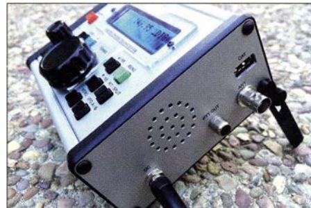
Bild 5: Auf der rechten Seite sind die Buchsen für 12 V, PTT, Antenne, CAT sowie der Lautsprecher angeordnet.
