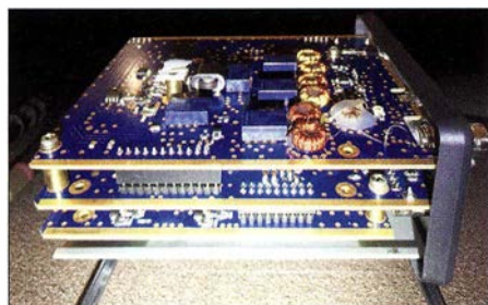
Bild 4: Innenansicht des LD-5 mit den vier dicht übereinander liegenden Leiterplatten
