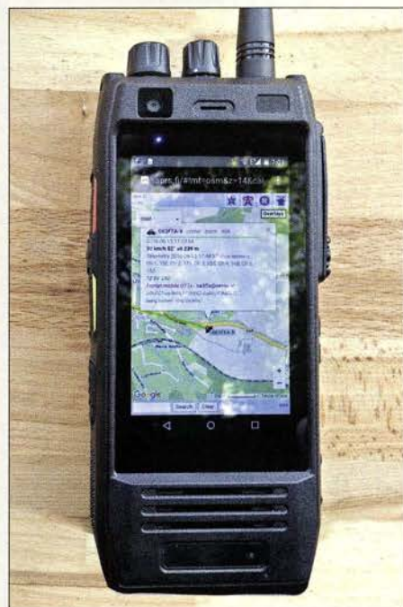
Für ein Amateurfunk-Handy relativ massig, dafür aber mit 6-Ah-Akkumulator und angenehm großem Display: Der am ÖVSV-Stand zu besichtigende Zwitter aus Android-Mobilteléfono und 70-cm-DMR-Handfunkgerät.
