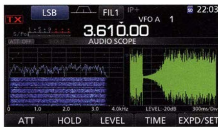
Bild 34: Impulsantwort der AGC auf einen steilflankigen Störimpuls
