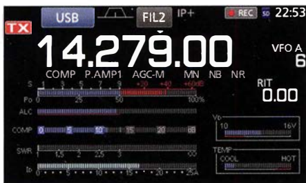
Bild 31: Die Gesamtansicht des Multifunktionsmeters beim Senden; oben zeigt Rec noch eine laufende Aufnahme an.
