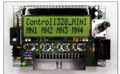
Bild 15: Leiterplatte Controller328_Mini mit Anzeige- und Bedienelementen
