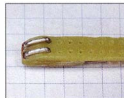
Bild 19: Die verwendeten Drähte bilden nach dem Durchfädeln auf einer Seite den Zwillingskontakt
