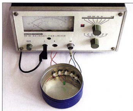
Bild 9: Messaufbau für die Bestimmung des LED-Stroms unterhalb der Schwellenspannung in Durchlassrichtung Foto: Seifert
