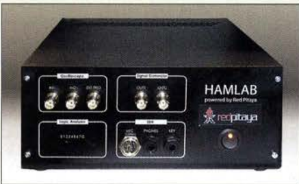
Der um ein HF-Fronend zum „Hamlab“ erweiterte Red Pitaya soll mit 10 W PEP senden und ab Herbst verfügbar sein.
