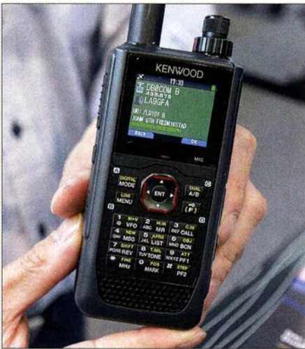
Alles dran – alles drin: Kenwoods noch namenloses neues 2-m/70-cm-Handfunkgerät bedient APRS dank integriertem GPS-Modul sowie neben FM auch D-STAR
