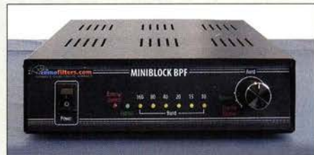
Für die klassischen KW-Bänder und 160 m entworfene Bandpassfilter zeigte der russische Hersteller Remo Filter. Die bis 200 W belastbaren Einzelfilter im MiniBlock BPF sind umschaltbar.
