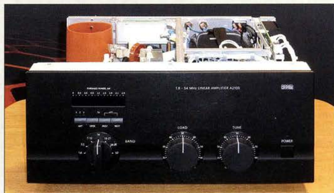
Der bulgarische Hersteller Acom setzt bei seinen Endstufen sowohl auf Röhren- als auch auf MOSFET-Konzepte; hier die neue Röhren-PA A2010, erhältlich bei Difona und WiMo.
